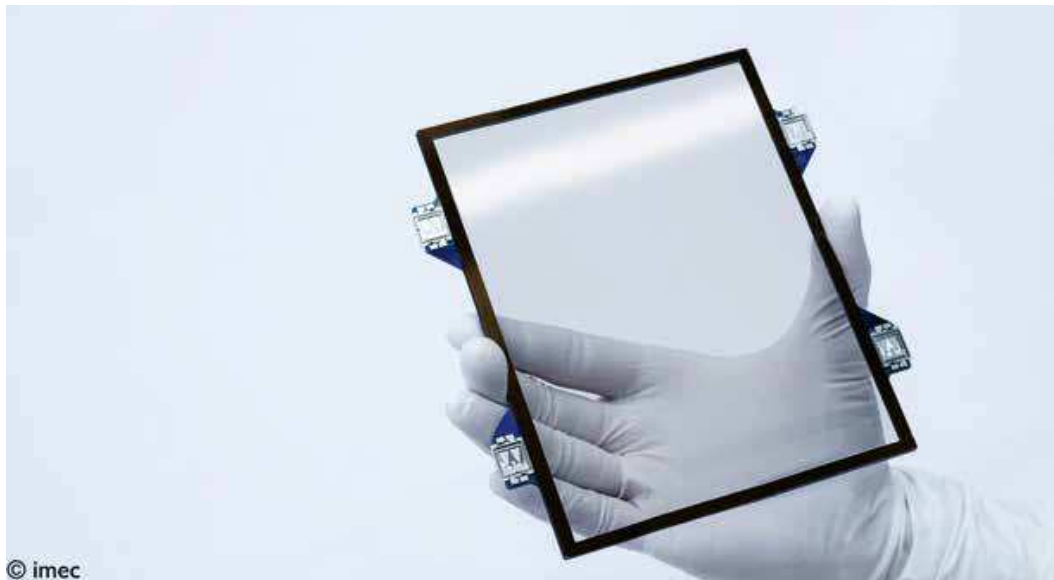
Afbeelding 4: EUV-filter gebaseerd op koolstofnanobuisjes vergelijkbaar met degene die 97% transparantie vertoonden voor EUV-licht.
